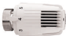
Termo glava STANDARD "Herz" sa hidrosenzorom Opseg zadavanja vrednosti 6-28°C. Zaštita od smrzavanja na 6°C. Mogućnost ograničavanja i blokiranja oblasti zadavanja pomoću graničnika (posebno se naručuje) Dimenzija: 1/2" Pakovanje: 20 kom.
