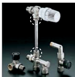
Usponski ventil gornji deo 1/2" Usponski ventil donji deo 1/2" 50% protok 100% protok Priključna steznica Cofit (označeno na slici) za spoj usponske cevi i ventila "Oventrop" - 2kom u setu Za kompletiranje usponskog ventila potrebna je ručna kapa ili termostatska glava
