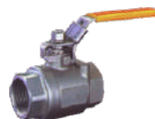
AISI 316 L kuglasti ventili navojni T do 200°C ; PN 63 bara
