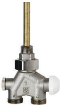
Uronski ventil za sušač za jednocevne i dvocevne sisteme "Herz" priključak grejnog tela sa donje strane, ravno zaptivanje, sa uronskom cevi L=150mm Dimenzija: 1/2" Pakovanje: 10kom.
