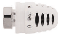
Termo glava MINI "Herz" sa hidrosenzorom Opseg zadavanja vrednosti 6-28°C. Zaštita od smrzavanja na 6°C. Mogućnost ograničavanja i blokiranja oblasti zadavanja pomoću graničnika (posebno se naručuje). Dužina 75mm, prečnik 45mm. Dimenzija: 1/2" Pakovanje: 20 kom.
