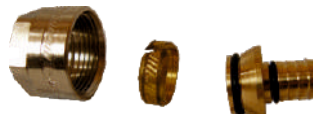
Adapter za Pex i Alupex cev "Herz" sastoji se od cevnog nastavka, steznog prstena i navrtke G 3/4 sa konusom. Dimenzije: Ø 16x2, Ø 18x2, Ø 20x2 Pakovanje: 10kom.
