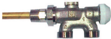
Uronski ventil za jednocevne i dvocevne sisteme "Herz" priključak grejnog tela sa donje strane, ravno zaptivanje, sa uronskom cevi L=290mm Dimenzija: 1/2" Pakovanje: 10kom.
