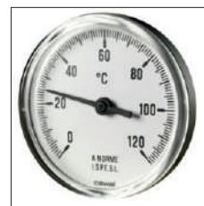
Bimetalni termometar ABS Temperatura 0 - 120°C Aksijalni priključak L 5 cm Dimenzija: Ø 80 - 1/2"
